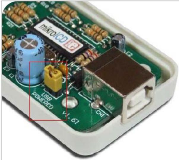
IL est à noter que le programmeur fournit lui-même la tension Vcc (+5V) au montage via le port USB. Si l'on désire que le montage soit alimenté extérieurement il faudra ouvrir le jumper placé à cet effet :
